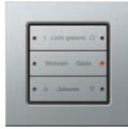
Der Gira Tastsensor 3 Komfort weist umfangreiche, praxiserprobte Softwarefunktionen auf. Die Tasten verfügen über dreifarbige Status-LEDs in den Farben Grün, Rot und Blau. Die Anzeigefarbe für den Status kann global, aber auch für jede Taste einzeln ausgewählt werden. Zudem ist es möglich, jeder Taste eine übergeordnete priorisierte Statusrückmeldung zuzuordnen, z. B. für Alarmmeldungen oder Hinweise wie Windalarm. Ein Temperatursensor ist ebenfalls integriert.
