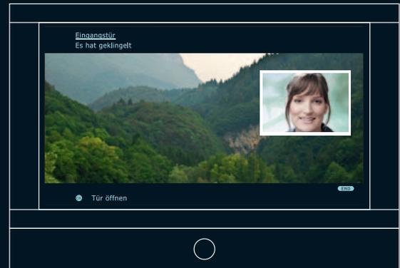
Beispiel: Picture-in-Picture-Übertragung des Kamerabildes der Gira Türstation auf dem Bildschirm mit der Option, die Tür zu öffnen
